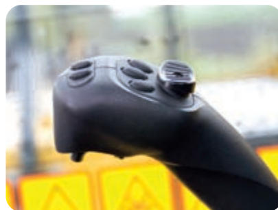
Bekväm, ergonomisk och exakt kontroll: joysticks med proportionell kontrollströmbrytare för redskap
