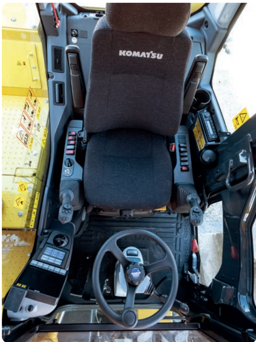
Bekväm, ergonomisk och exakt kontroll: joysticks med proportionell kontrollströmbrytare för redskap
