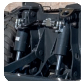
Schaktblad/stödbensylindrar med integrerad backventil (standard)
